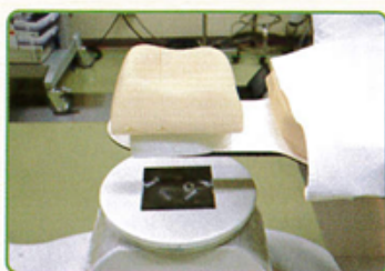
④ 血管造影装置の既存ビス穴を利用し、特製ビスでX線遮蔽装置を固定
